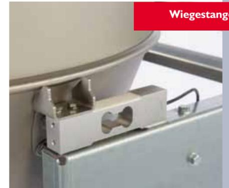
Mischer-Waage mit Wechselventil
