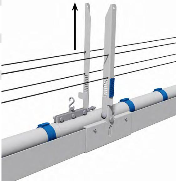
In der **Dosierungsposition** liegt das Transportrohr in einer voreingestellten Position, mit der **10 Level Höhenverstellung** im Futtertrog eingestellt und wird das Futter im volumetrischen Teleskop-Spender dosiert.
